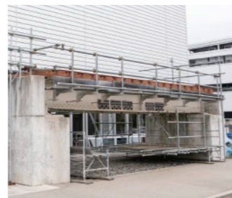
鋼桁・吊足場モデル
