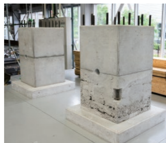
良・不良柱コンクリート構造モデル
